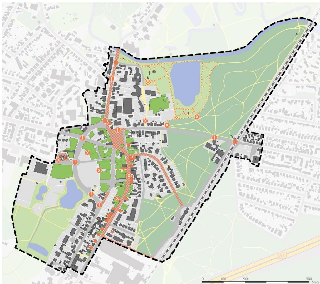
Abb. 162: Analyseplan zur Barrierefreiheit im öffentlichen Raum. Gesamtplan in A3 im Anhang.
