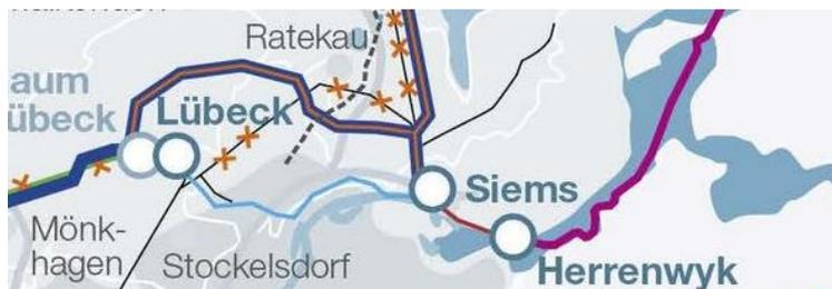
Der *Trassenverlauf* der 380-kV-Ostküstenleitung. Im Raum Lübeck wird die bestehende 220-kV-Leitung durch die *neu* zu errichtende 380-kV-Leitung ersetzt.
